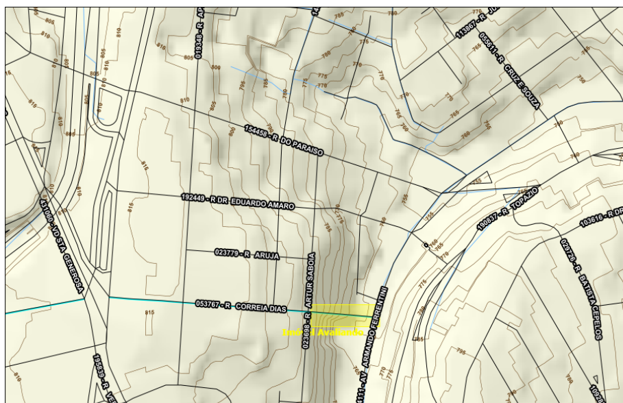
Figura 4 – Levantamento planialtimétrico (curvas de nível no local do imóvel).
